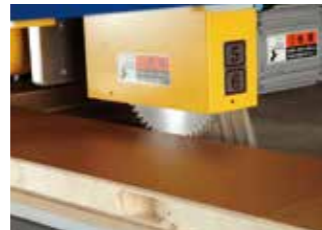
垂直 90度旋回鋸軸
